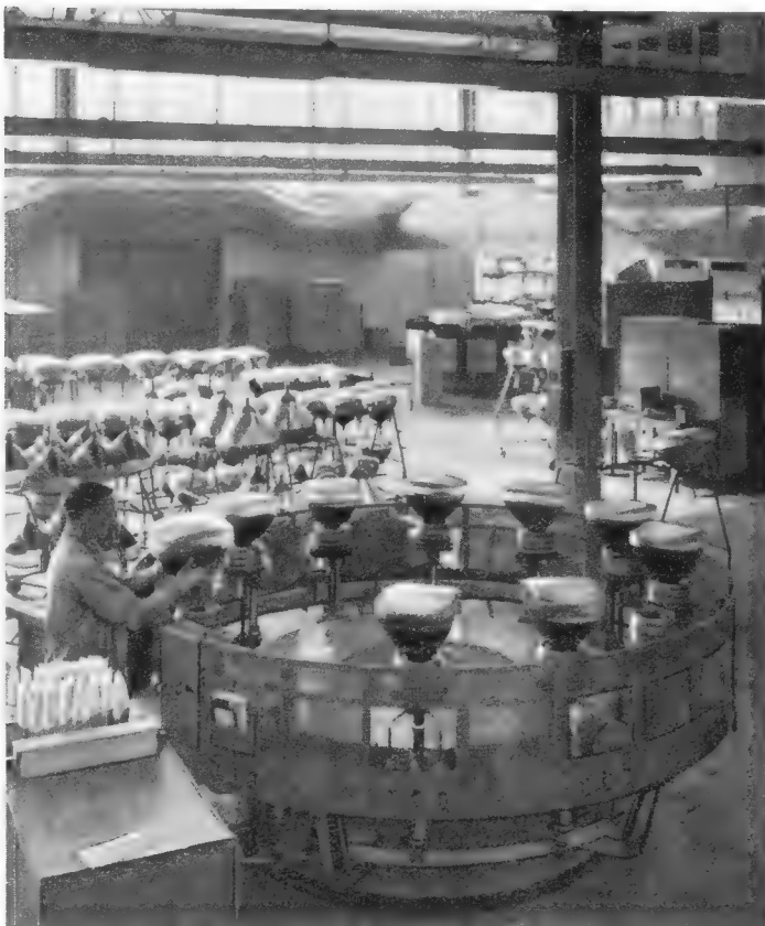
Bild 2. Karussell für das automatische Einschmelzen der Bildröhrensysteme in den Glaskolben. Die Systeme (links) sind einzeln zum besonderen Schutz gegen Staub mit Plastikhüllen versehen
