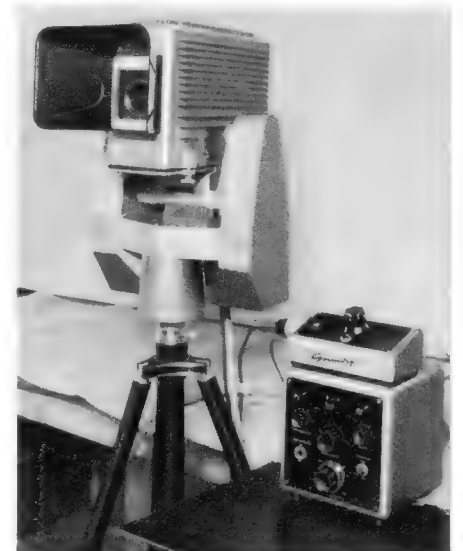
Bild 9. Grundig-Fernauge mit Schwenkkopf und Geräten für Fernbedienung aller Kamerafunktionen
