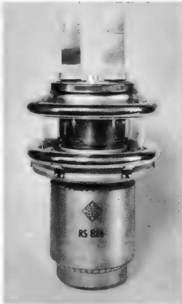
Bild 3. Telefunken-Senderöhre RS 826 mit achsparallelen Bohrungen in der dickwandigen Anode für Kanalkühlung
