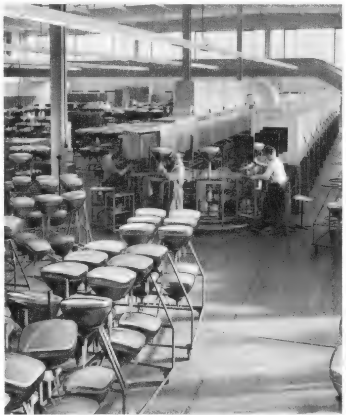
Bild 3. Blick auf die Ovalbahn der Pumpeinheiten für Bildröhren. Jeder Röhre ist ein als Wagen konstruierter Pumpstand zugeordnet. Sie durchlaufen (im Bild rechts) einen Tunnelofen mit verschiedenen Heizzonen und hochfrequenten Glühvorrichtungen, um das erforderliche Vakuum zu erzielen
