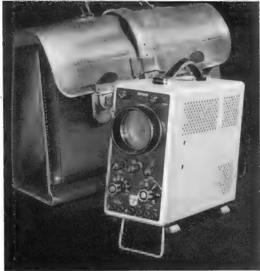
Bild 2. Der besonders handliche und vielseitige Klein-Oszillograf GM 5650 von Philips
