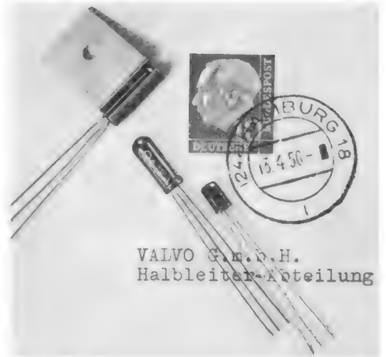
Bild 7. Valvo-Transistoren im Vergleich zu einer Vakuumröhre; links oben Flächentransistor OC 72 mit Kühltülle, darunter OC 71, daneben Miniatur-Transistor OC 65
