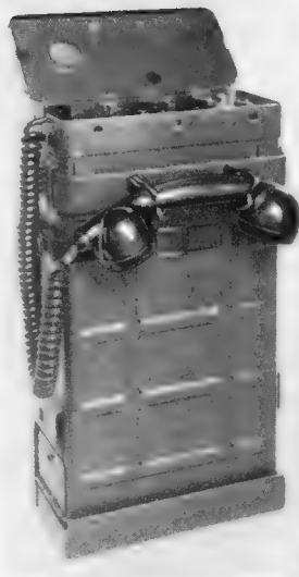
Links: Bild 7. 15-Watt-Funksprechgerät FuG 7 von Telefunken für transportablen Einsatz Rechts: Bild 8. Fahrbare Zentrale für ein Funknetz mit FuG 7
