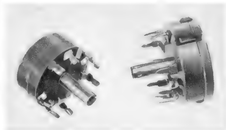
Bild 6. Röhrenfassungen für gedruckte Schaltungen; die Anschlüsse sind für Tauchlötung ausgebildet (K. Lumberg)
